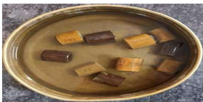
चित्र 2. जल अवशोषण के लिए बाँस के नमूने
