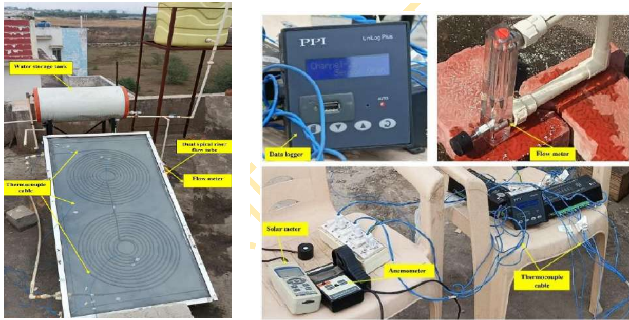
चित्र - 1 (क) परीक्षण किए गए सौर जल तापक का फोटोग्राफिक दृश्य और (ख) प्रयोग के लिए उपयोग किए गए उपकरण।
