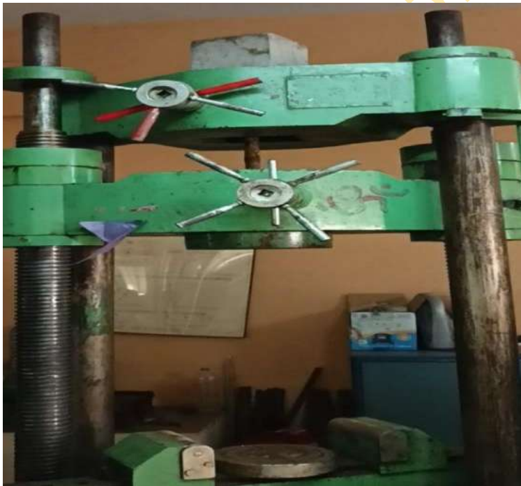
चित्र - 5. यूनिवर्सल टेस्टिंग मशीन में नमूने का खिंचाव परीक्षण
