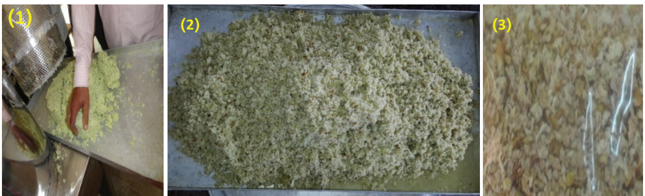
चित्र 2: (1) आंवला घर्षणी द्वारा आंवला कतरन (श्रेड्स) तैयार करना (2) आंवला के श्रेड्स (3) सूखे हुए आंवला श्रेड्स
